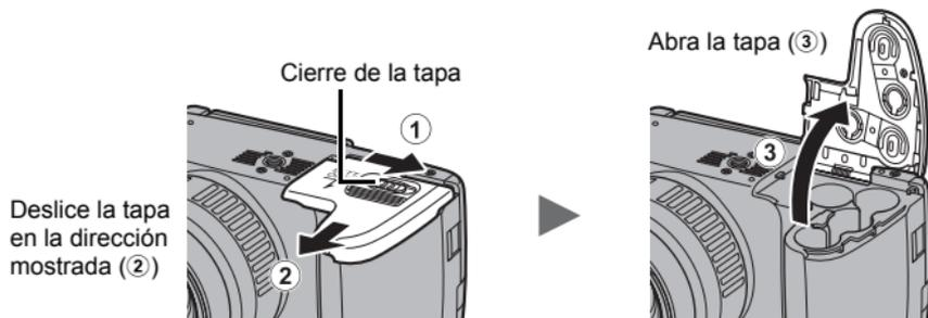
2. Instale las cuatro baterías/pilas.
