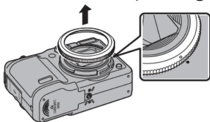
**4 Alinee la marca ○ del anillo con la marca ● de la cámara y, a continuación, gire el anillo en la dirección de la flecha.**
