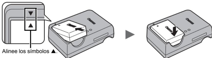
2. Conecte el cargador de batería (CB-2LZ) a una toma de corriente, o bien conecte el cable de alimentación al cargador de batería (CB-2LZE) y enchúfelo a la toma de corriente.
