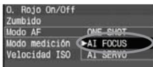
El modo AF AI Foco cambia el modo AF del modo AF simple al modo AF AI Servo automáticamente si un motivo estático empieza a moverse.
