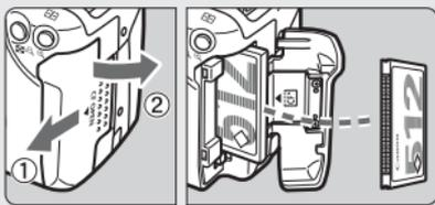
**Abra la tapa de la ranura de la tarjeta CF e introduzca una tarjeta CF.** (p. 26)
