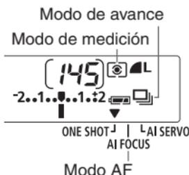
Dispone de los modos de medición evaluativa, parcial y promediada con preponderancia al centro. Dispone de los modos de avance único, continuo y con temporizador. Seleccione el modo de medición adecuado para el motivo o para su intención fotográfica.
