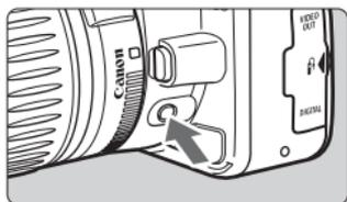
Presione el botón de previsualización de la profundidad de campo para cerrar el diafragma hasta el ajuste de abertura actual. El diafragma del objetivo se cerrará hasta la abertura actual para que pueda comprobar la profundidad de campo (intervalo de enfoque aceptable) en el visor.
