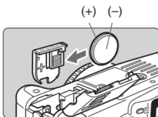
**4** Coloque la pila nueva.
