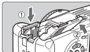
**5** Inserte el soporte de la pila y cierre la tapa.
