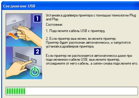
Чтобы включить принтер, нажмите сторону выключателя питания, обозначенную символом " | ".
