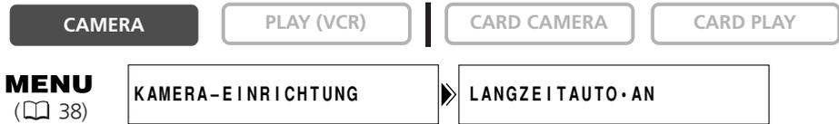
Öffnen Sie das Menü, und wählen Sie [KAMERA-EINRICHTUNG]. Wählen Sie den Posten [LANGZEITAUTO], setzen Sie ihn auf [AUS], und schließen Sie das Menü.
