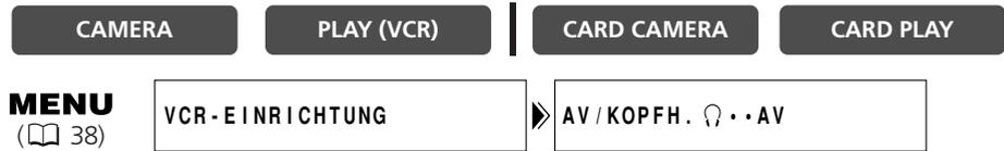
Öffnen Sie das Menü, und wählen Sie [VCR-EINRICHTUNG]. Wählen Sie den Posten [AV/KOPFH. 🎧], setzen Sie ihn auf [KOPFHÖRER 🎧], und schließen Sie das Menü.
