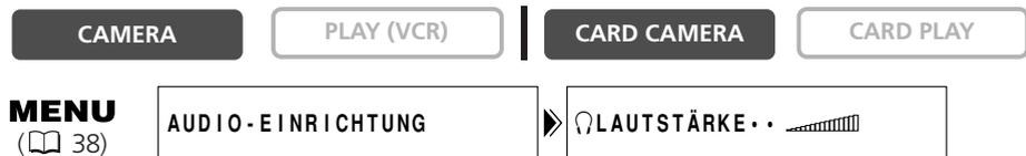
Öffnen Sie das Menü, und wählen Sie [AUDIO-EINRICHTUNG]. Wählen Sie [🎧 LAUTSTÄRKE], stellen Sie die Lautstärke mit dem SET-Rad ein, und schließen Sie das Menü.
