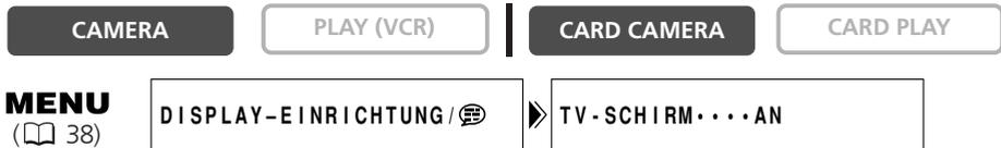
Öffnen Sie das Menü, und wählen Sie [DISPLAY-EINRICHTUNG/ ]. Wählen Sie den Posten [TV-SCHIRM], setzen Sie ihn auf [AUS], und schließen Sie das Menü.
