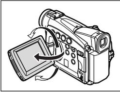
Der LCD-Monitor ist drehbar. Klappen Sie den LCD-Monitor unbedingt auf die 90°-Stellung auf, bevor Sie ihn drehen.
