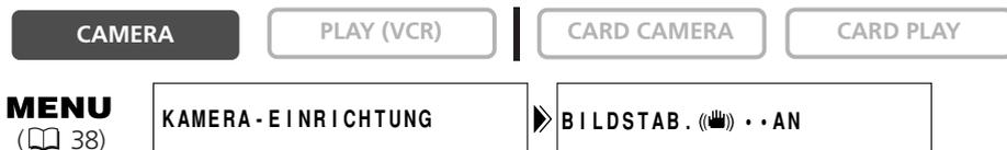
Öffnen Sie das Menü, und wählen Sie [KAMERA-EINRICHTUNG]. Wählen Sie den Posten [BILDSTAB. (👉)], setzen Sie ihn auf [AUS], und schließen Sie das Menü.
