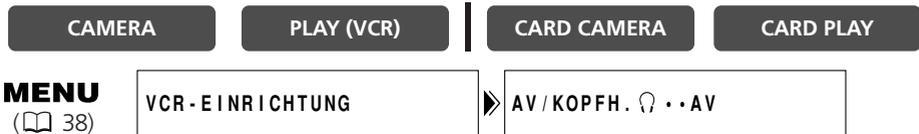
Öffnen Sie das Menü, und wählen Sie [VCR-EINRICHTUNG]. Wählen Sie den Posten [AV/KOPFH. 🔊], setzen Sie ihn auf [KOPFHÖRER 🔊], und schließen Sie das Menü.
