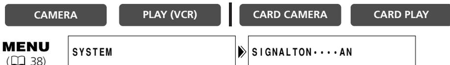
Um den Signalton auszuschalten, öffnen Sie das Menü, und wählen Sie [SYSTEM]. Wählen Sie den Posten [SIGNALTON], setzen Sie ihn auf [AUS] und schließen Sie das Menü.
