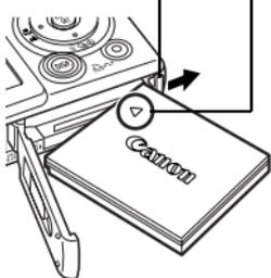
**2** Halten Sie die Akkuverriegelung gedrückt, während Sie den Akku vollständig einschieben, bis er hörbar einrastet.
