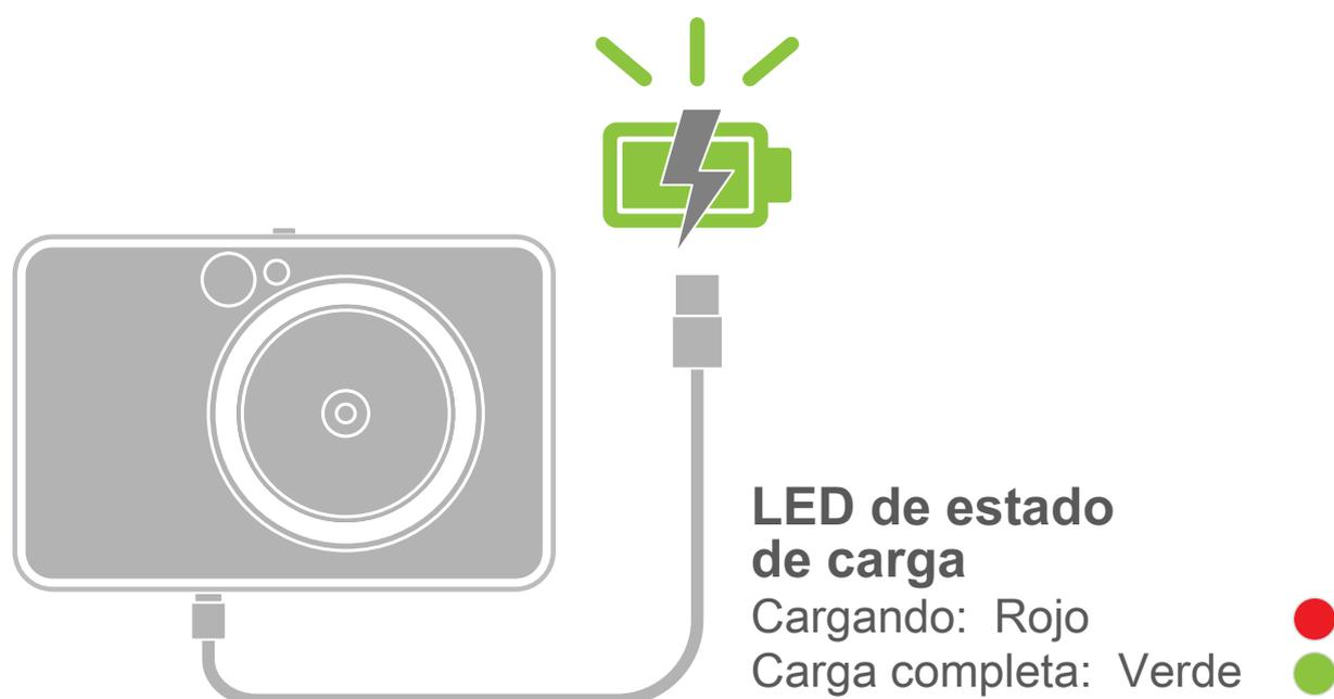
El dispositivo lleva una batería incorporada. Carga por completo la batería del dispositivo mediante el cable USB proporcionado antes de usarlo por primera vez.
