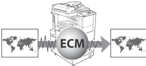
La función de fax de este equipo es compatible con ECM (modo de corrección de errores). ECM corrige las transmisiones de fax con errores, distorsionadas o de mala calidad producidas por el ruido de la línea. También le permite enviar o recibir faxes de alta calidad aunque el estado de su línea
