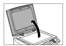
Очистите стекло планшета и нижнюю поверхность крышки стекла планшета влажной тканью. Затем протрите эту область мягкой сухой тканью.
