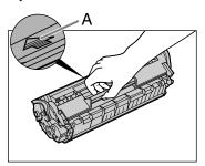
Вставьте картридж таким образом, чтобы выступ с правой стороны картриджа с тонером (А) вошел в направляющую (В), расположенную с правой стороны аппарата, и опустите картридж вниз параллельно направляющей.
