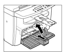
12 Сложите стопор для бумаги, затем вдвиньте удлинитель выводного лотка в аппарат.
