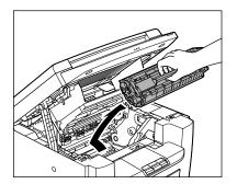
Аккуратно 5 – 6 раз покачайте картридж для равномерного распределения тонера.
